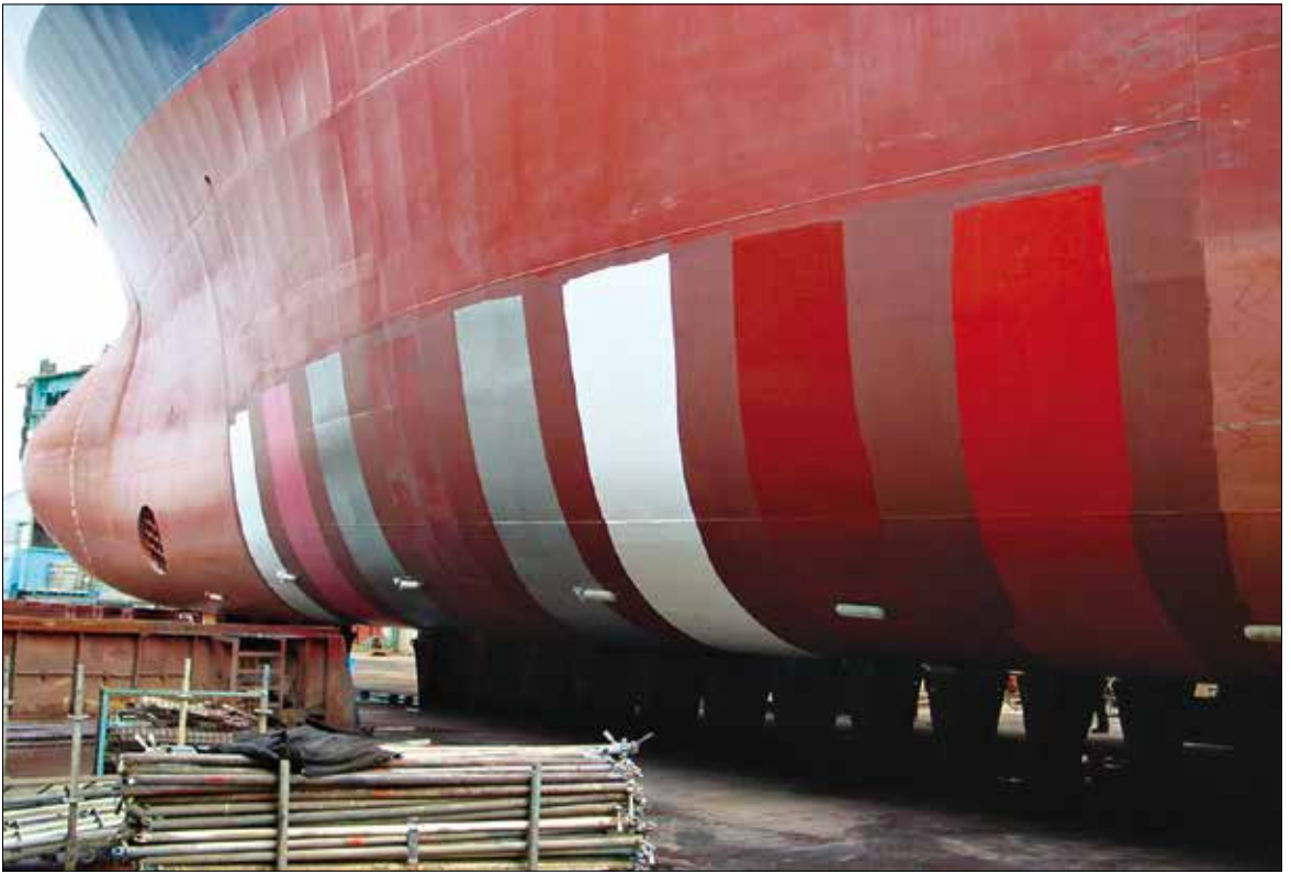
Teststreifen mal anders: Verschiedene Antifouling-Anstriche auf demselben Schiffsrumpf ermöglichen einen Vergleich.
